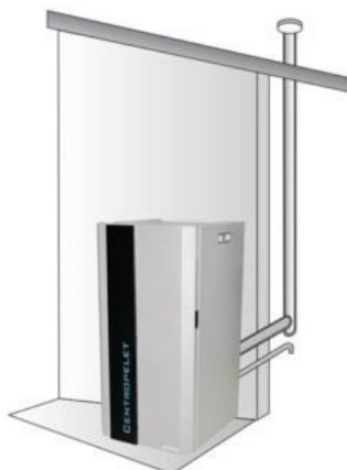
Odprowadzanie spalin Kominy zewnętrzne, które muszą być połączone zgodnie z lokalnymi przepisami.
