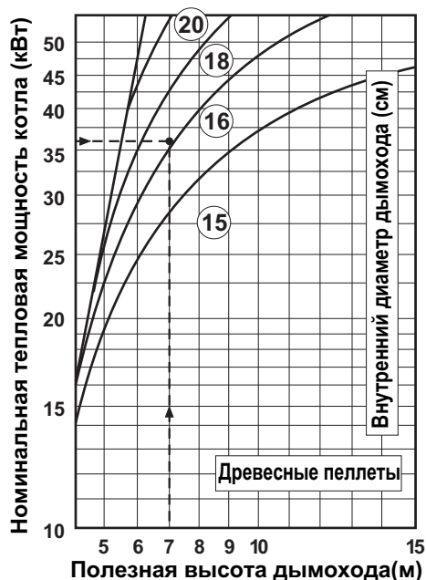
Рис. 4. Выбор размера дымохода для PelTec
