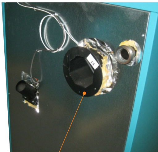
Фланец для монтажа вентилятора
