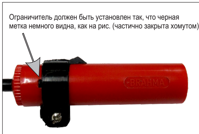
Рис. 2. Осторожно вставить фотоэлемент в держатель на коробке до ограничителя
